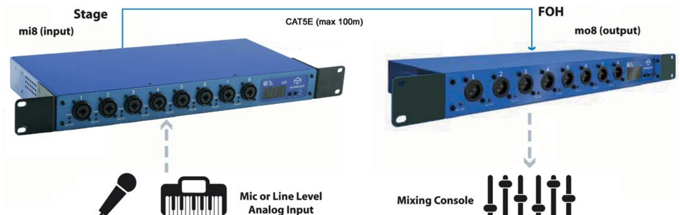
Principio di base della configurazione dei Digital Snake System
